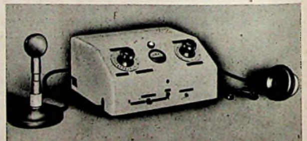
Ein neues Audiometer von Siemens-Reiniger mit Mikrofon-Sprechkreis. Rechts Luftschallhörer, Knochenleitungshörer, Druckknopf
