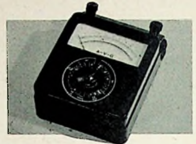
Abb. 2. Mikroampere-Multizet von S & H; kleinster Meßbereich 20 µA, Spannungsbereiche 50000 Ohm/V
